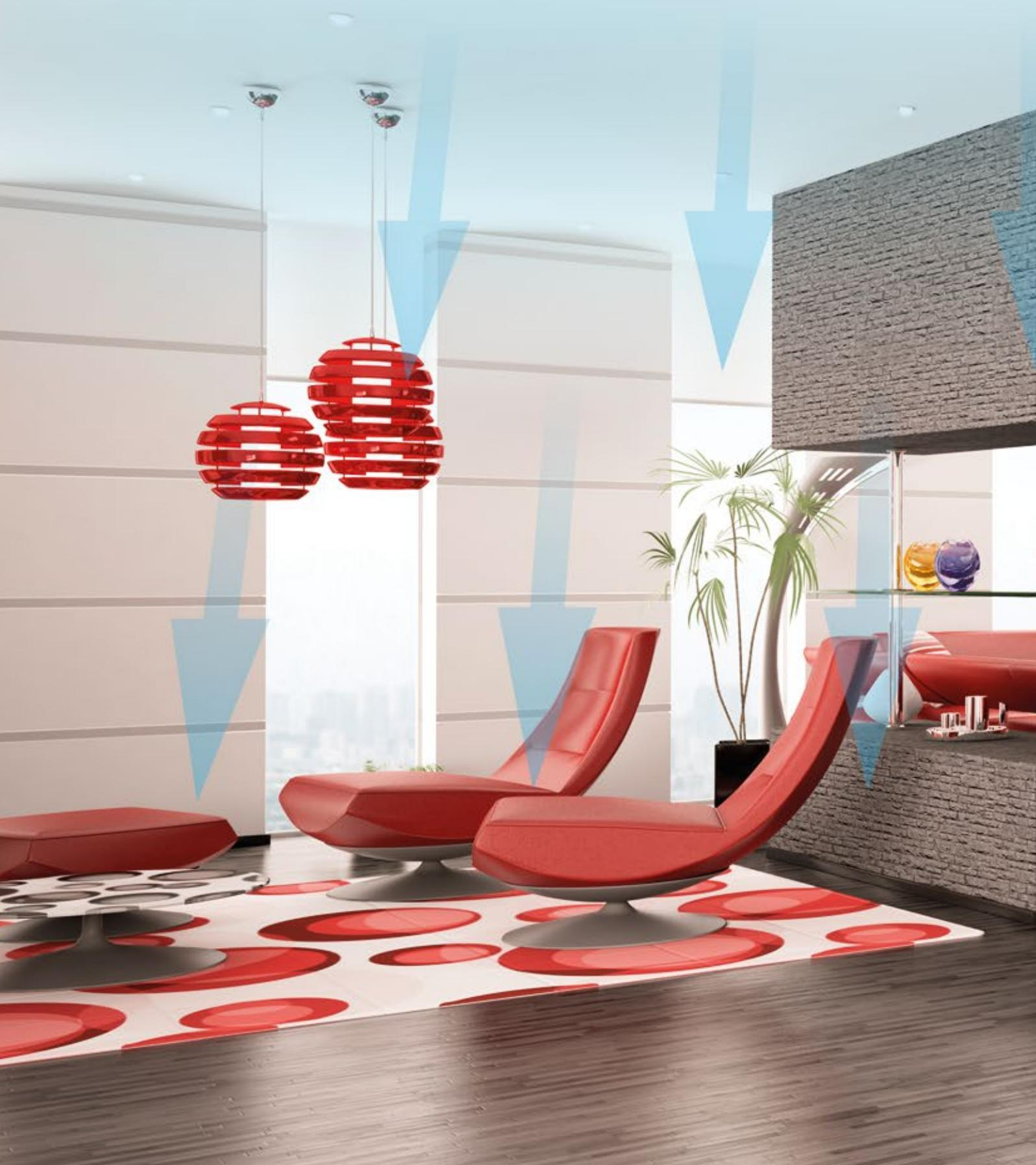
По трубам, встроенным в потолочную конструкцию, протекает холодная вода, отбирающая тепло из охлаждаемого помещения. Благодаря большому объему лучистой энергии охлаждает в первую очередь пол и стены, благодаря чему создает приятную среду с равномерным распределением температуры.
