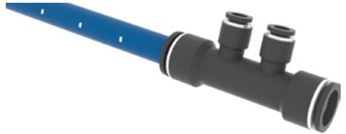
После осуществления монтажа соединенные детали можно повернуть, трубу можно вынуть, сжав соединительное кольцо. При повторном монтаже трубу следует снова смазать и проверить, не произошло ли повреждения.
