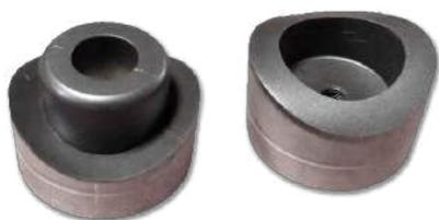
Необходимая насадка для правильного монтажа вварных седел всех типов. Форма насадки повторяет радиус главной трубы и обеспечивает совершенное и качественное соединение седла с поверхностью главной трубы.
