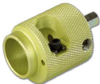
Приспособление, представляющее собой насадку для всех стандартных типов ручных дрелей, предназначено для быстрого и простого устранения алюминиевого покрытия и калибровки труб FV PPR STABI перед их сваркой.
